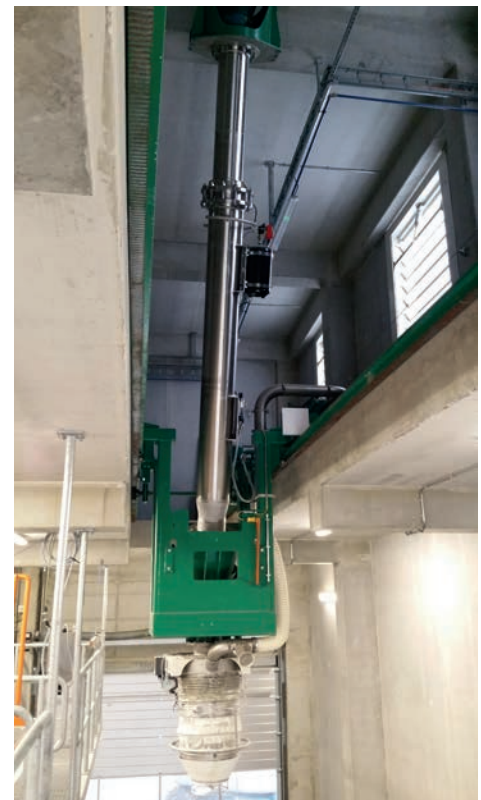
Afb. 3 Een positioner om achtereenvolgens de verschillende compartimenten van een bulkwagen te vullen
